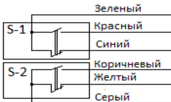
Рисунок 2. Схема подключения сигнализатора давления.
